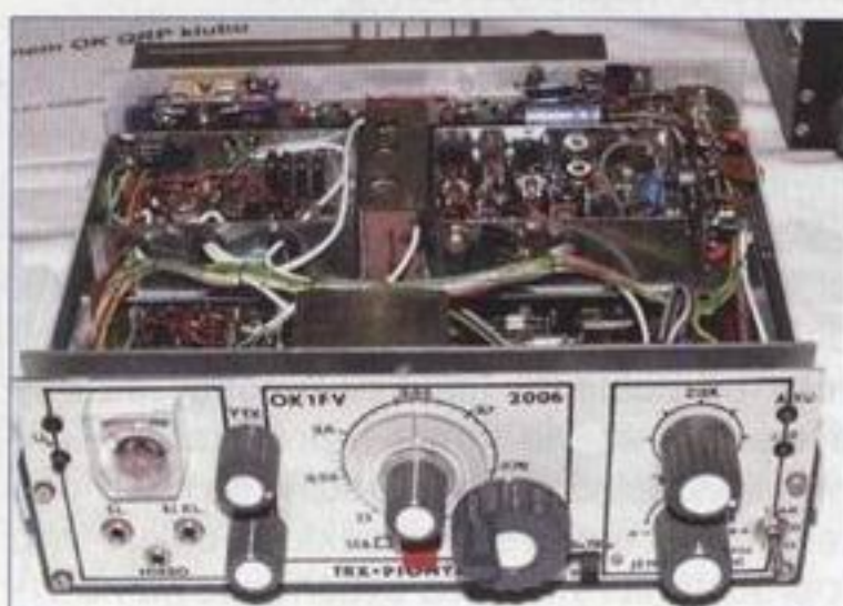
Obr. 5. Tento přístroj vám možná bude připadat trochu povědomý. Původně to byl KV přijímač Pionýr, který na konci 70. let minulého století vyráběl podnik Radiotechnika Svazarmu. Vašek, OK1FV, a Libor, OK1FPL, ho o řadu let později doplnili o 10W vysílač a dali tak vzniknout transceiveru stejného jména. Byl k vidění ve stánku OK QRP klubu
