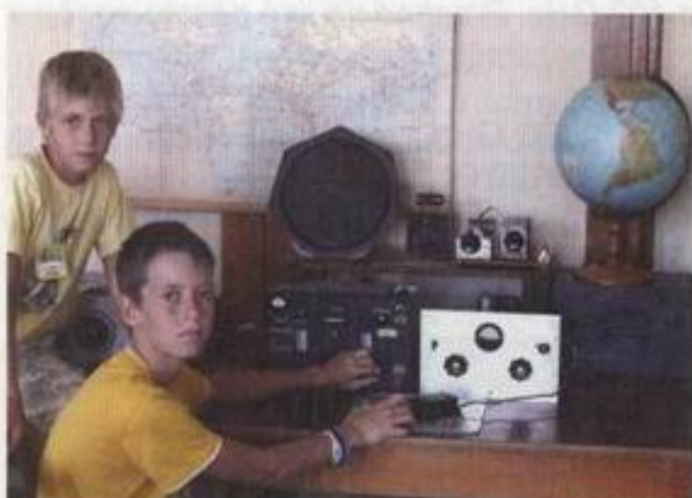
Obr. 4. V historické expozici Ing. Viktora Křížka, OK1XW, byl letos představen plně funkční ham-shack z 50. let minulého století, vybavený hlavně technikou, která tu zbyla po wehrmachtu: přijímač Torn E.b., vysílač home made z inkurantních součástek, v PA elektronka LS50. Antény v té době se používaly vesměs drátové
