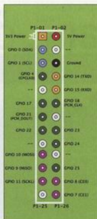
Zapojení systémového konektoru a ovládání vývodů (GPIO) z webové stránky
