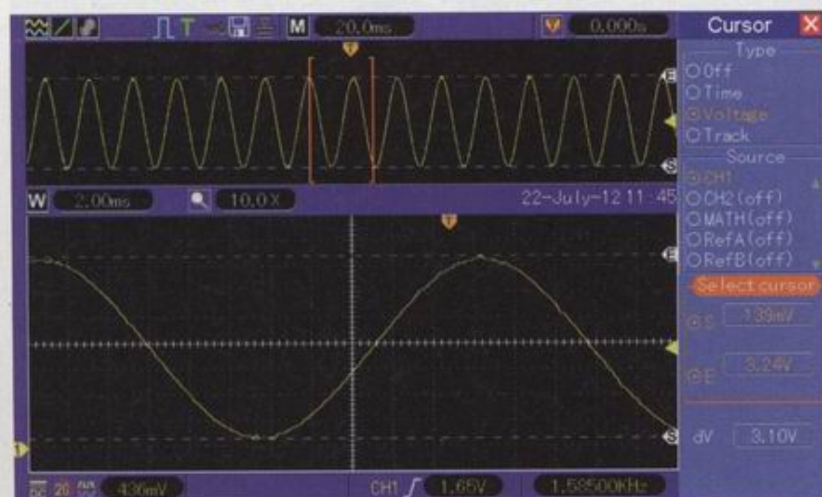
Obr. 29. Průběh signálu na výstupu generátoru DDS
