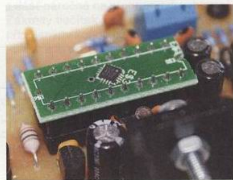
Obr. 8. Destička s obvodem SI4735
