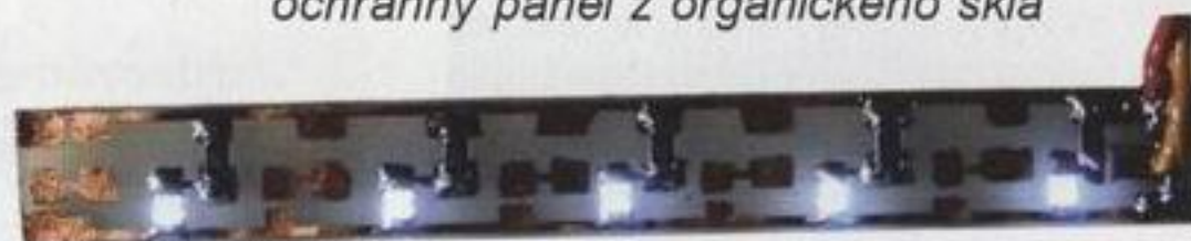
Obr. 4. Vnitřní osvětlení bílými SMD LED
